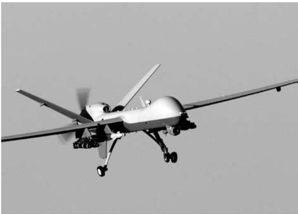
*Diese unbemannte Reaper-Drohne der amerikanischen Streitkräfte dient in erster Linie dem Angriff. Sie wird unter anderem in Afghanistan eingesetzt und trägt üblicherweise lasergelenkte Bomben sowie lasergesteuerte Luft-Boden-Raketen. Nur für den Start und die Landung wird ein lokaler Pilot benötigt. Sie kann bewegliche Ziele verfolgen, erfassen und bekämpfen. Sie ist ca. 11 m lang mit einer Flügelspannweite von über 20 m.*
