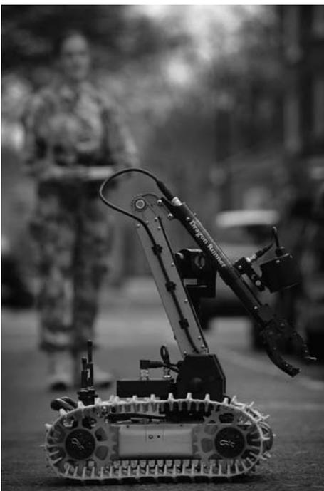
Der Dragon Runner kann im Rucksack mitgeführt werden und wird zur Beseitigung von Sprengfallen eingesetzt.
