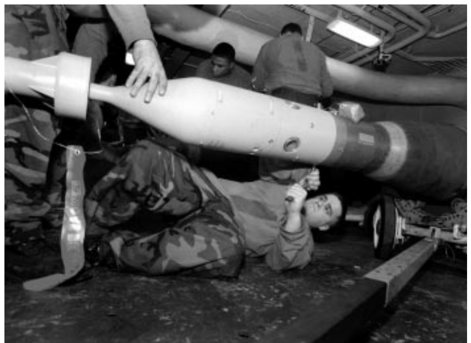
Die Präzision moderner Waffensysteme steigt stetig an: Montage einer Laser-Zieloptik an eine 2000-Pfund-Bombe. Quelle: Homepage des Pentagon
